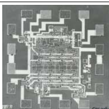
Рис.31,г – ИС РУ 401. ЗУ с произвольной выборкой: 16 разрядов. t_{сч} = t_{ап} = 5 нс, P=22,5 мВт/бит. N=148 шт. 2Ме.
