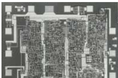
Рис. 31,з – ИС 500PY402. ИС ассоциативного ЗУ на 4 бит: t_{зр}=2 нс, t_{поиск}=4 нс, t_{зап}=6 нс, P=25 мВт. N=260 шт. Двухслойная система металлиза- ции-2Ме.
