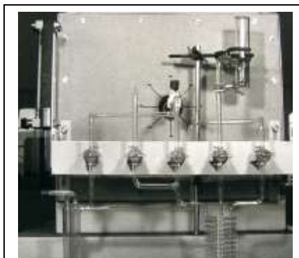
Рис. 5. Газовая система зарубежной печи типа «Vacwell».
