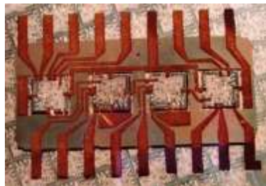
Рис.30,в. Многокристалльная сборка (МКС) на подложке из Si с локальными отверстиями.
