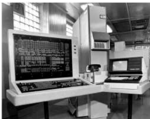
Рис. 1. Традиционный пульт ЦП МВК Эльбрус-2.
