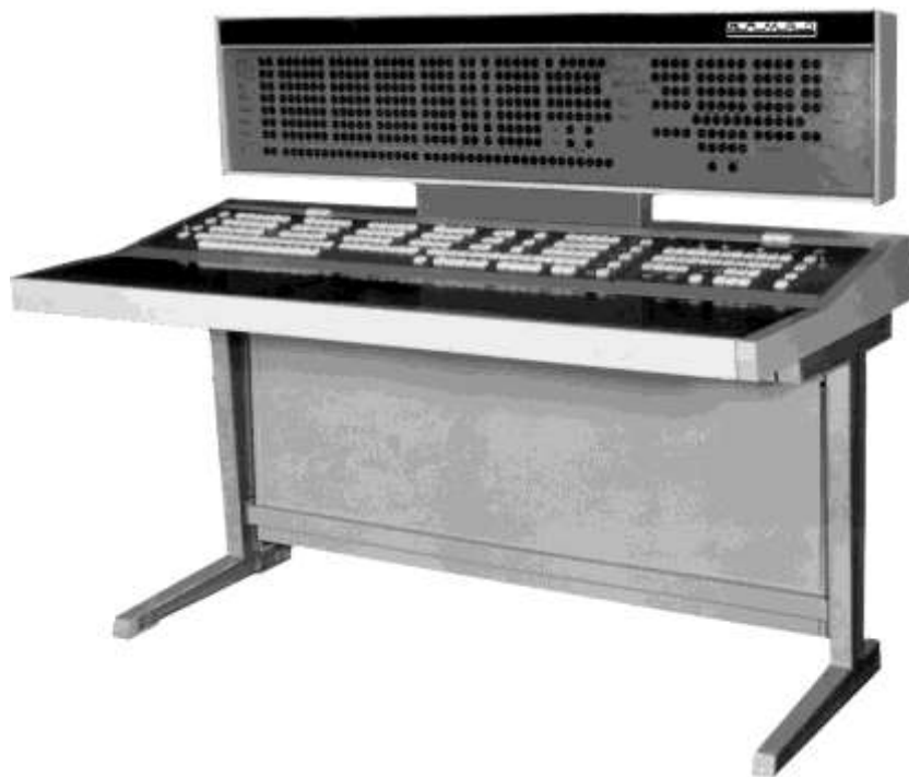
Рис. 12. Инженерный пульт управления ЭВМ Алмаз
