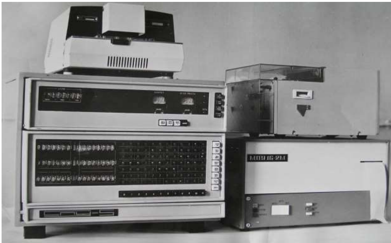
Фото 16. Трех-координатная система управления СПУ - 5.
