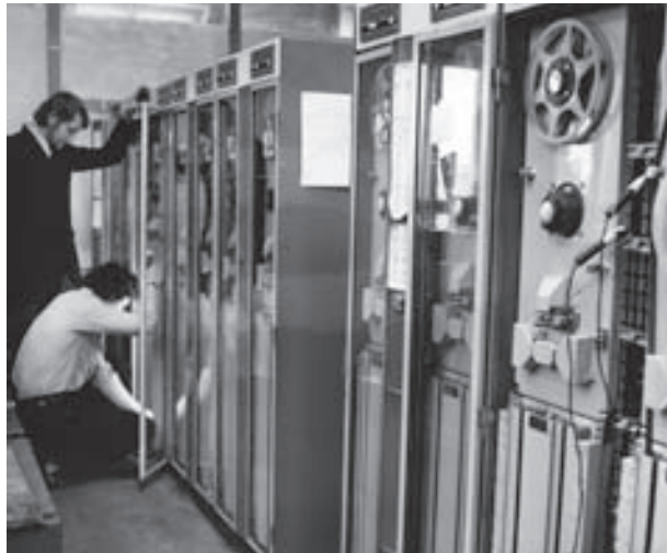
БЭСМ-4. Зал с накопителями на магнитных лентах
