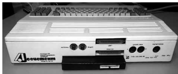
«Ассистент-128»: разъемы: вставлен контроллер дисководов (вид сзади)
