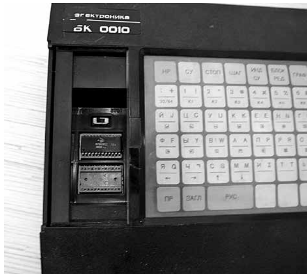
БК-0010: панельки и переключатель сброса
