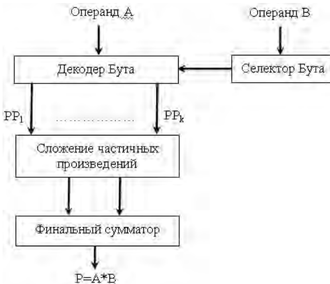
Рис.6. Обобщенная структурная схема умножителя на основе алгоритма Бута.
