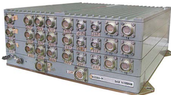
Рис. 14. Программируемый микроконтроллер КС020-М
