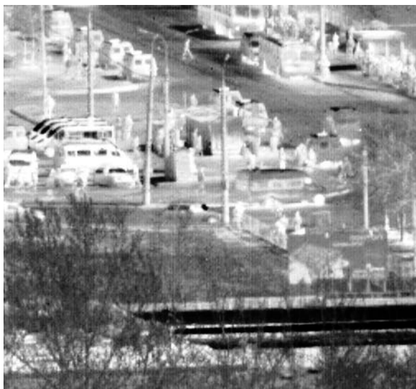
Рис. 33. Пример изображения, формируемого в БЭО
