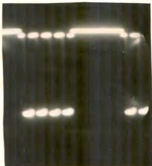
Рис. 1У-14. Работа 4-го триггера контрольного числа (КБ-1) при выполнении операции «проверить» или «образовать значения в контрольных разрядах» (в 31-ом разряде ПЦМ — «1»)
