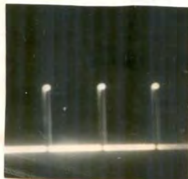
Рис. IV-10. Импульсы „подпора“ дешифраторов приема в „В“ и „С“ на выходе БК
