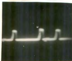
Рис. IV-8. Импульсы „подпора“ дешифраторов приема в СР из ПР
