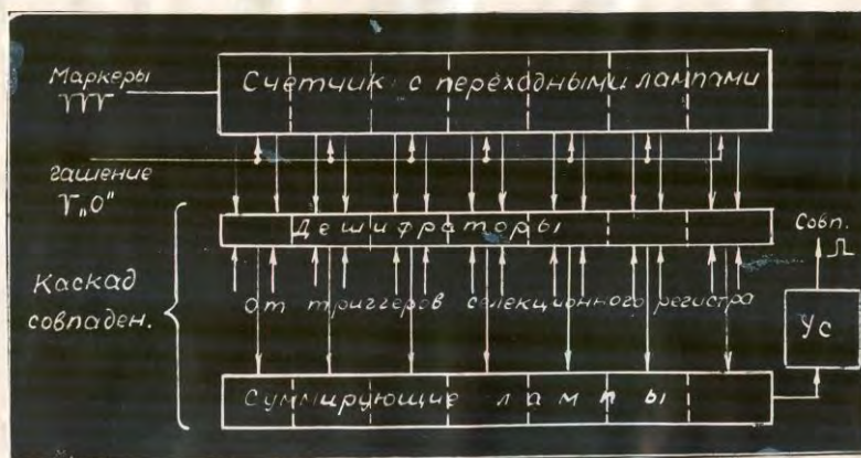
Рис. III-8 Скелетная схема регистра сравнения
