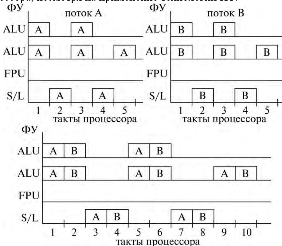
Рис. 22.8. Пример, когда применение технологии НТ не дает выигрыша в производительности
