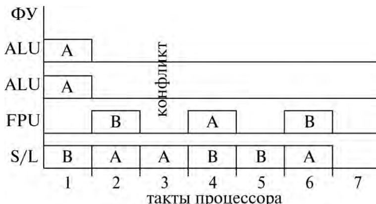
Рис.22.7. Возникновение конфликтных ситуаций при применении технологии НТ
