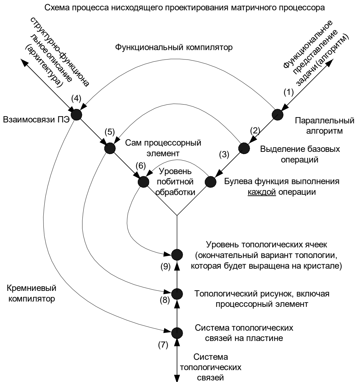
Рис.17.2 Схема нисходящего проектирования матричного процессора
