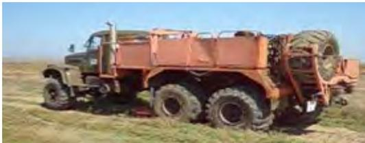
Рис. 2.4.16 Сейсмический вибратор СВ-10/100
