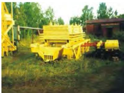
Стационарный центробежный виброисточник ЦВ-100 дебалансного типа создает возмущающую силу амплитудой 100 т. Эффективный диапазон частот 5,5–8,5 Гц
