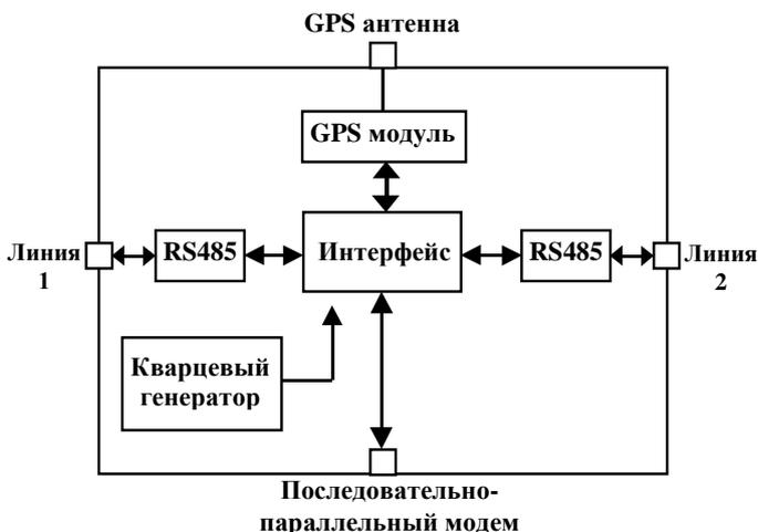
Рис. 2.4.22 Структура и свойства центрального модуля
