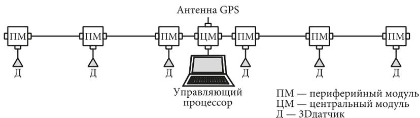
Рис. 2.4.20 Структурная схема приемника РОСА
