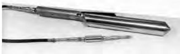
Рис. 2.4.19 Схема скважинного сейсмоприемника СС-3
