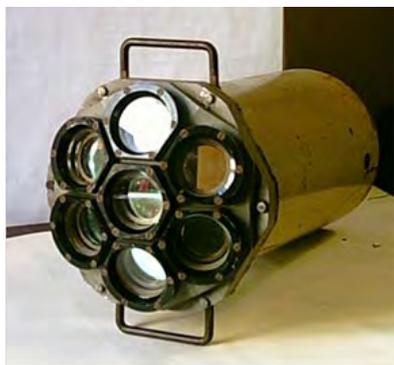
**Рис. 2.3.6** Подводный приемный модуль для оптической линии связи»
