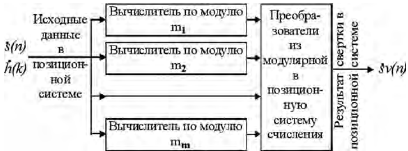
Рис. 4. Функциональная схема фильтра
