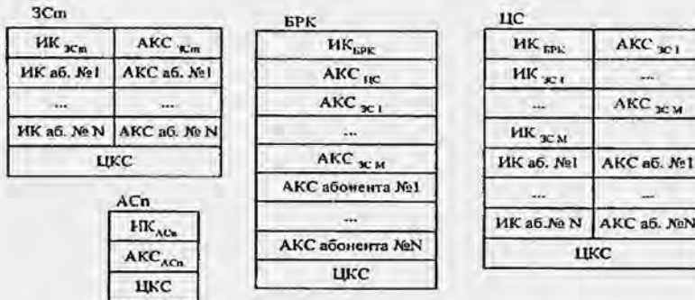
Рис. 3. Распределение ключей между элементами ГСС
