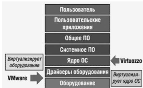
**Рис. 5. Уровни реализации Virtual Machine и Virtual Private Server (на примере технологий VMware и Virtuozzo)**
