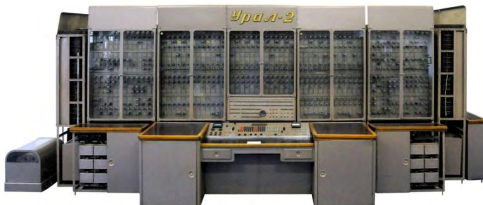
Машина «Урал-2» была первой отечественной серийной машиной среднего класса с трёхмерной ферритовой памятью и первой, к которой стали подключать алфавитно-цифровое печатающее устройство (АЦПУ). По объёму оборудования (2280 ламп, 10 000 диодов) она равна самой массовой зарубежной ламповой двухадресной машине IBM-650, но многократно (в 4–5 раз) превосходила её по скорости вычислений.
