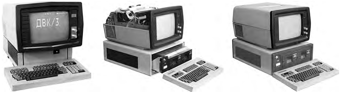
Рис. 58. Варианты унифицированного моноблока ДВК-3 и ДВК-4 (в центре – со встроенным сверху принтером)
