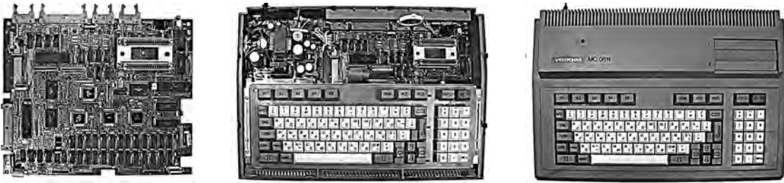
Рис. 66. Школьная ЭВМ «Электроника УК-НЦ» (MC 0511): плата, внутреннее устройство, внешний вид
