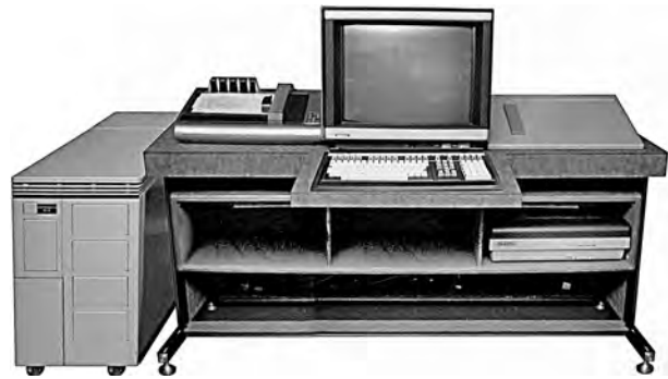
Рис. 72. «Электроника НЦ-ИРС-32» с графопостроителем (слева), дигитайзером (справа) и принтером (на столе)
