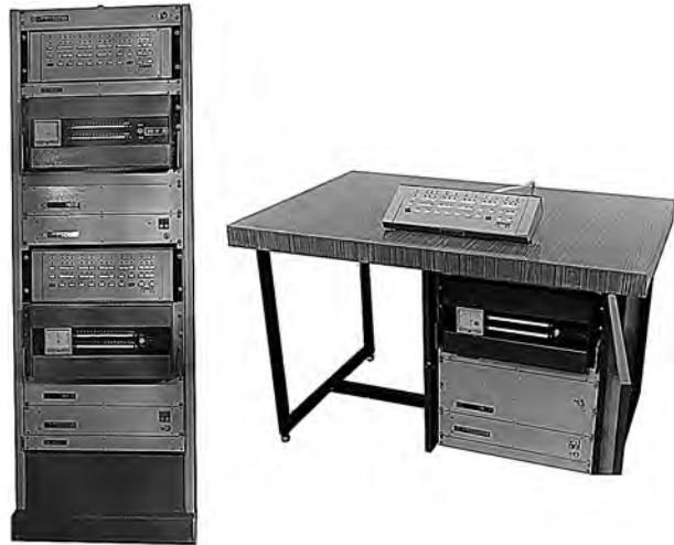
Рис. 41. Стойка МКТК «Электроника НЦ-32» и его абонентский пункт
