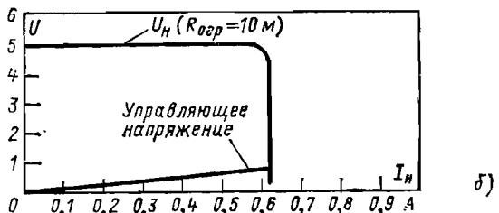
Рис. 7-22. Схема стабилизатора с ограничением тока (пунктиром показана схема защиты от перегрузок) (а) и его выходная характеристика (б).
