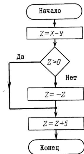
Рис. 14. Структурная схема программы, приводимой в табл. 3.
