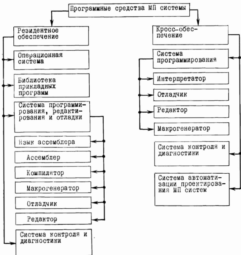
Рис. 12. Упрощенная структура программных средств МП системы.
