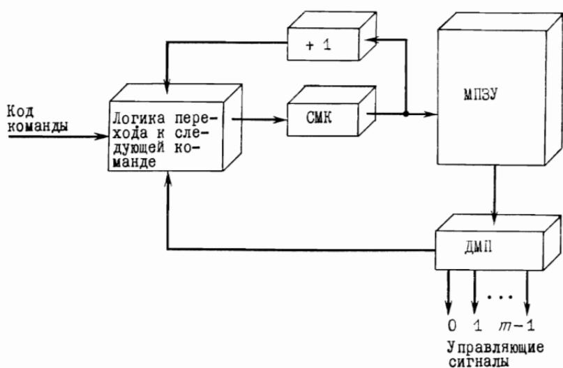
Рис. 10. Общая схема микропрограммного управления.
