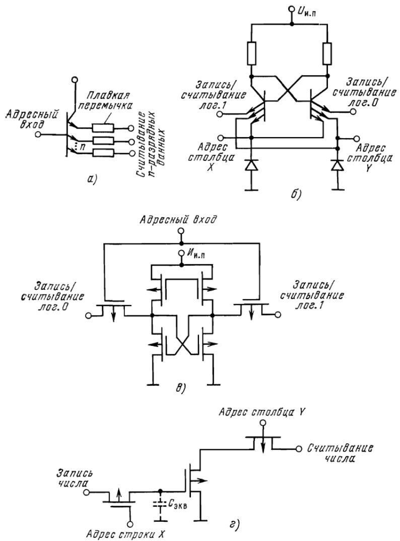
Рис. 6. Принципиальные электрические схемы запоминающих ячеек полупроводниковых ЗУ.
