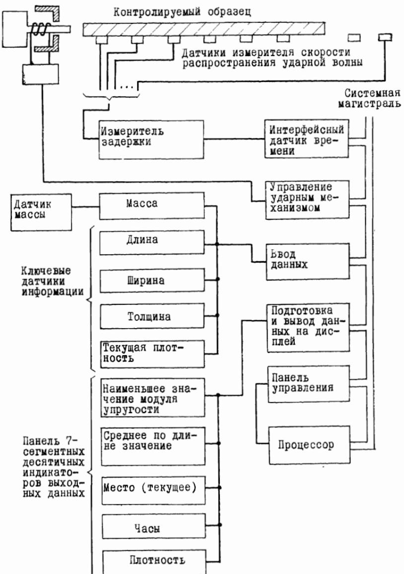
Рис. 20. Функциональная схема системы сортировки пиломатериалов.
