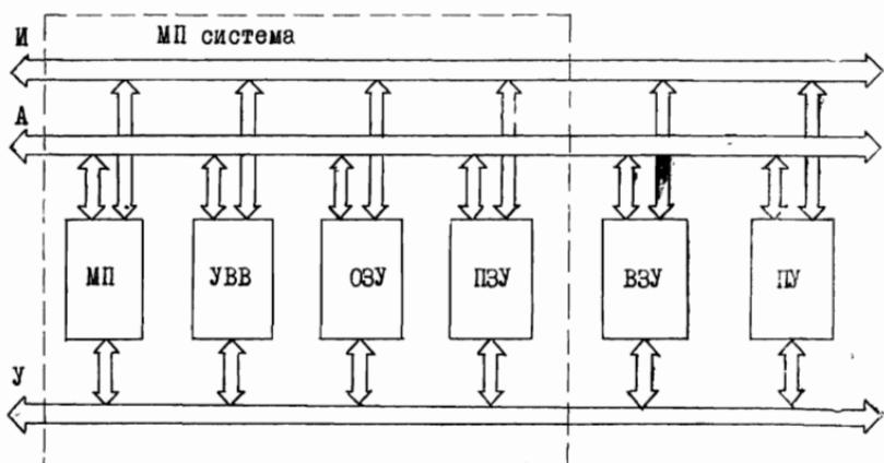
Рис. 7. Обобщенная структурная схема микропроцессорной системы.
