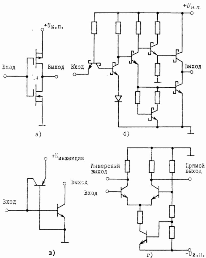
Рис. 15. Схемы базовых логических элементов КМОП (а), ТТЛШ (б), И<sup>2</sup>Л (в) и ЭСЛ (г).
