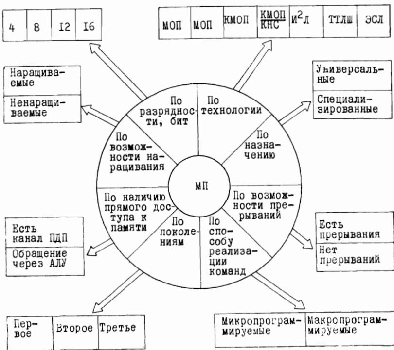
Рис. 17. Классификация микропроцессоров.
