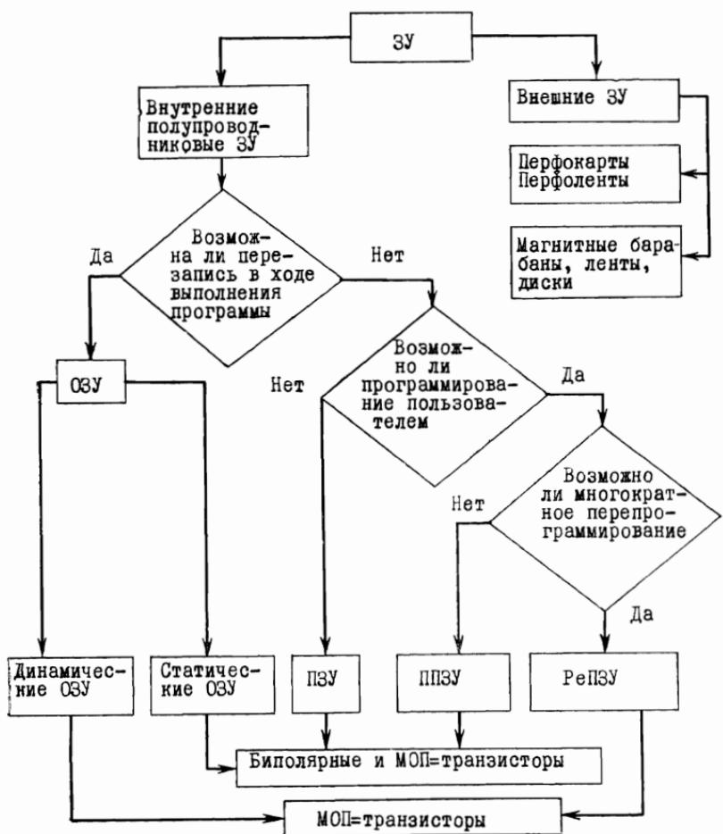
Рис. 4. Классификационная схема запоминающих устройств.
