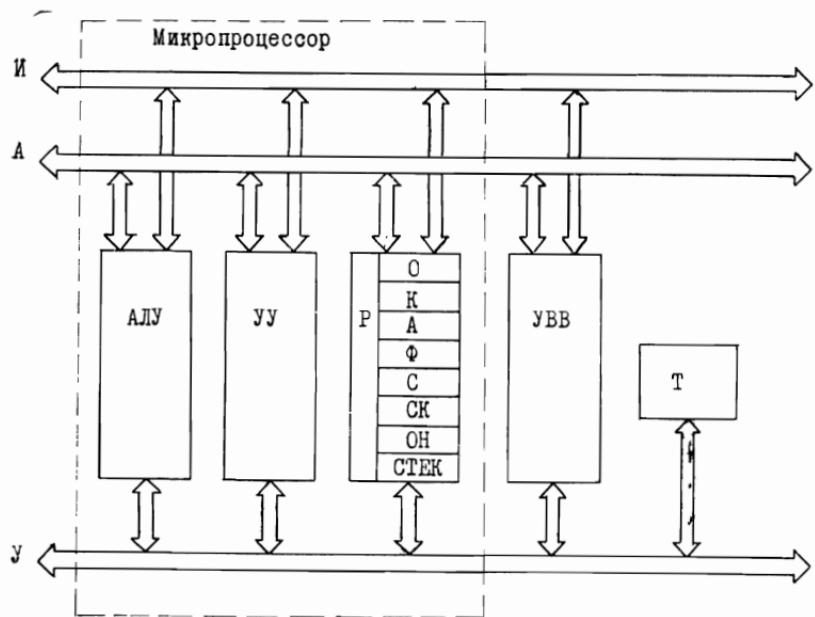
Рис. 2. Обобщенная структурная схема МП с тремя раздельными шинами информационных (И), адресных (А) и управляющих (У) сигналов.
