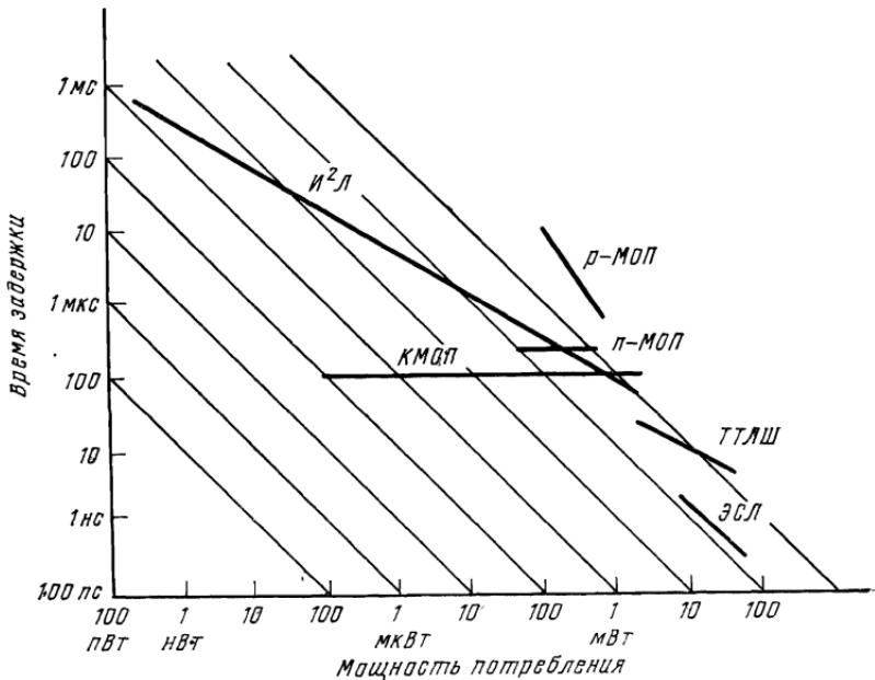
Рис. 16. Сравнение диапазонов изменения быстродействия и мощности потребления логических элементов, выполненных различными схемотехническими способами.
