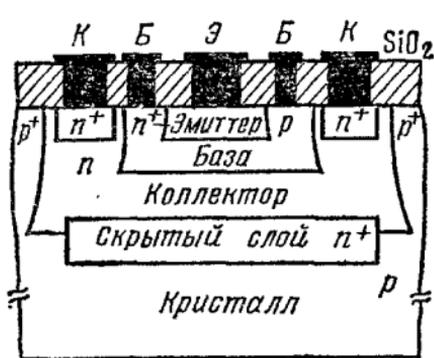
Рис. 1.4. Интегральный биполярный транзистор, изолированный электронно-дырочным переходом
