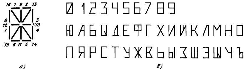
Рис. 99. Изображения знаков на основе 16-сегментного индикатора
