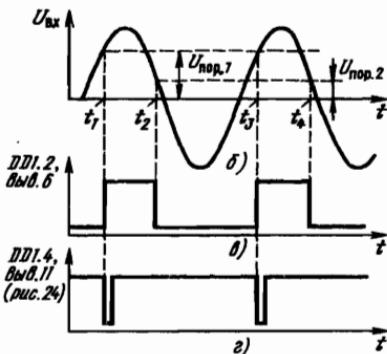
пряжение на входе триггера снизилось примерно до 0,5 В (момент  $t_2$ ), оба элемента переключились в первоначальное состояние. На выходе триггера вновь появился высокий уровень напряжения.
