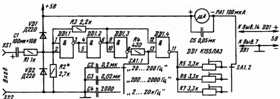
Рис. 24. Принципиальная схема простейшего частотометра
