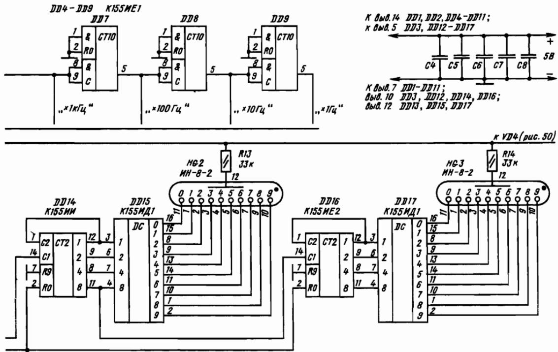
Рис. 48 (правая часть). Принципиальная схема частотометра
