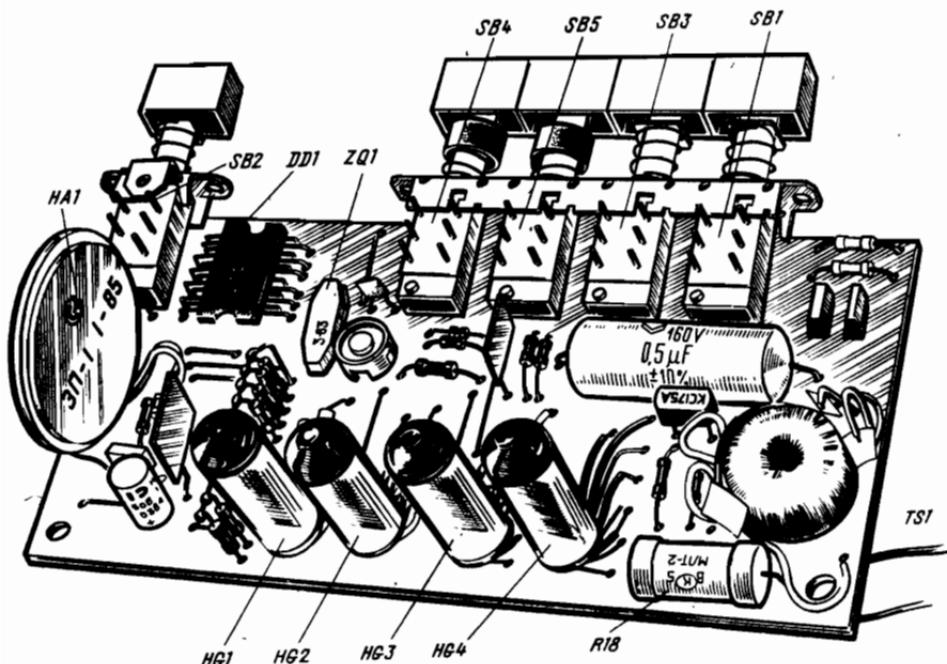
Рис. 64. Монтаж деталей часов на плате
