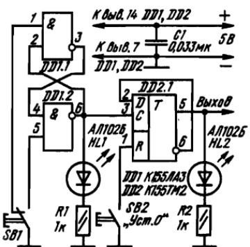
Рис. 35. Ключевое устройство с RS-триггером на входе
