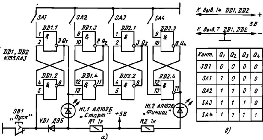
Рис. 28. Схема игрового автомата на RS-триггерах
