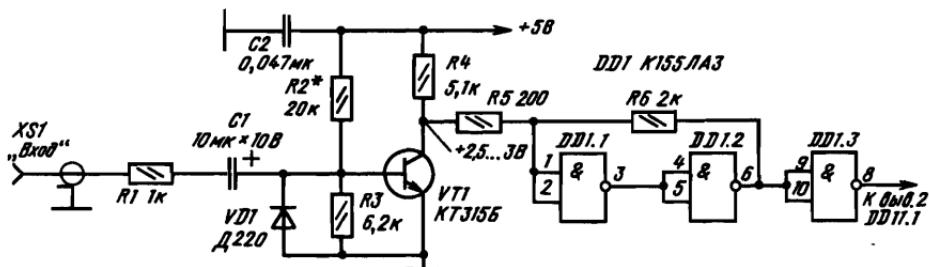
Рис. 58. Схема формирователя импульсного напряжения на логических элементах микросхемы K155ЛА3
