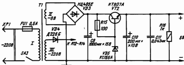
Рис. 50. Схема блока питания
