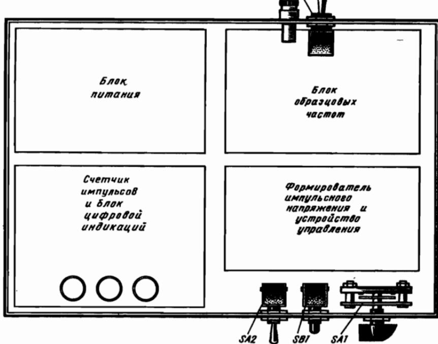
Рис. 52. Размещение блоков и деталей цифрового частотомера в корпусе
