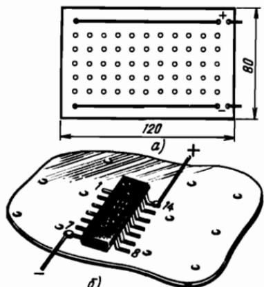
Рис. 7. Макетная панель для опытной проверки работы микросхем
