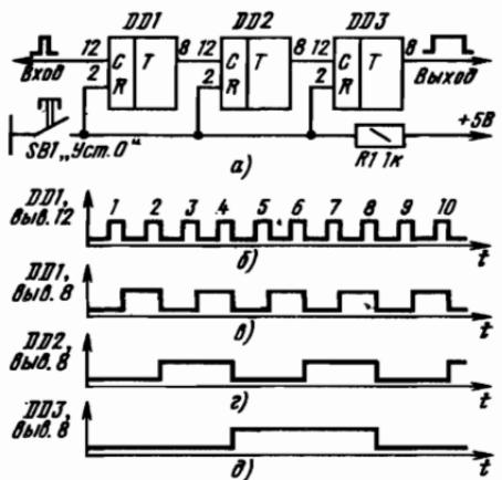
Рис. 39. Трехразрядный двоичный счетчик импульсов
