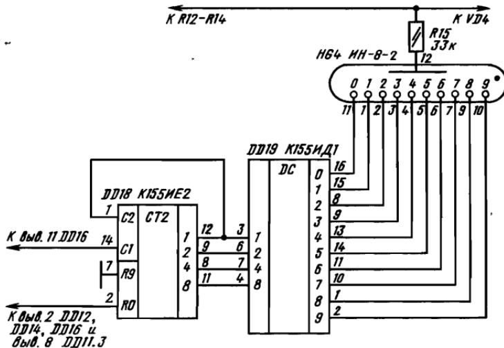
Рис. 60. Схема дополнительной счетной ступени блока цифровой индикации
