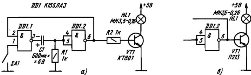
Рис. 15. Схема игрового автомата
