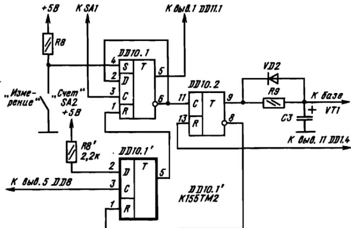
Рис. 59. Схема устройства управления с дополнительным D-триггером
