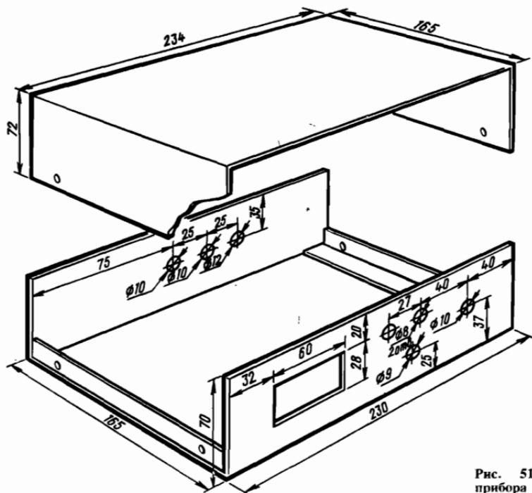
Рис. 51. Корпус прибора
