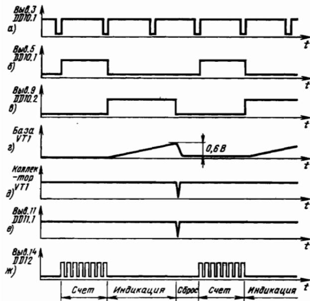
Рис. 49. Графики, иллюстрирующие работу управляющего устройства цифрового частотометра
