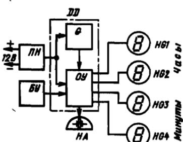
Рис. 62. Структурная схема электронных часов
