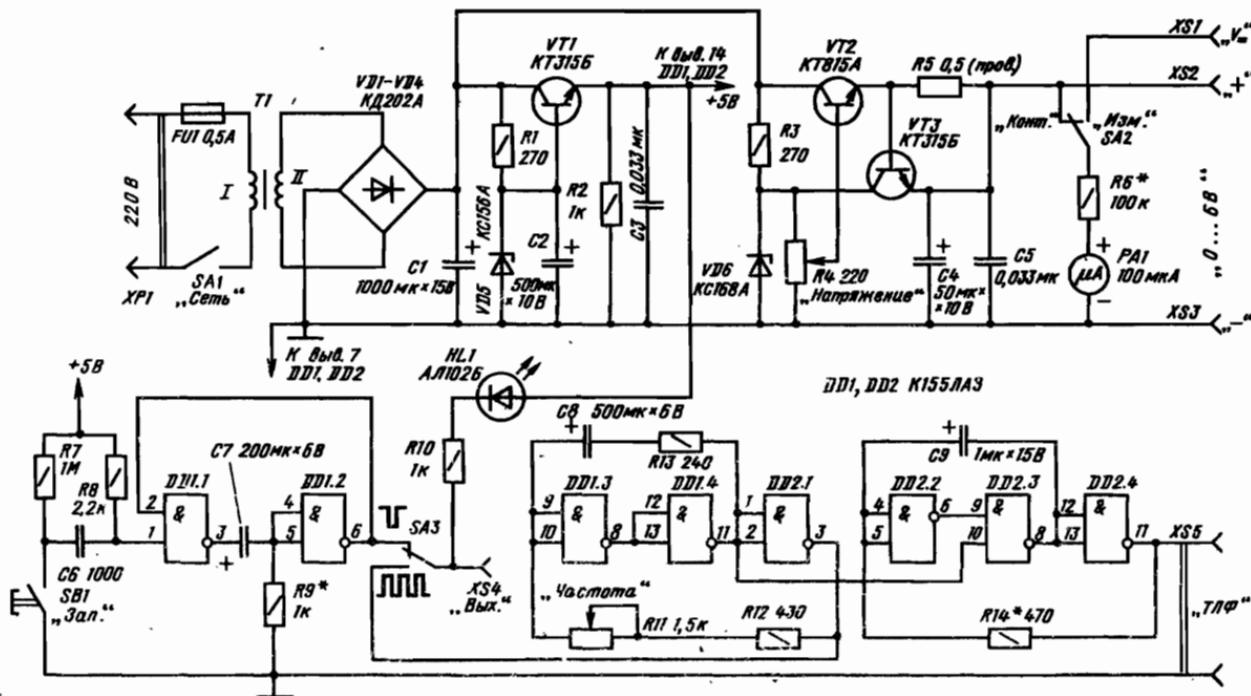
Рис. 20. Схема сетевого блока питания с генераторами испытательных импульсов
