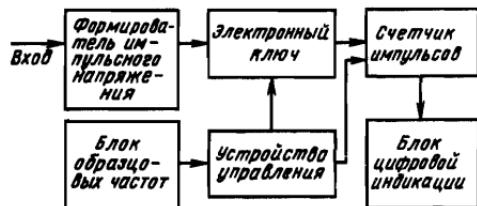
Рис. 47. Структурная схема частотомера
