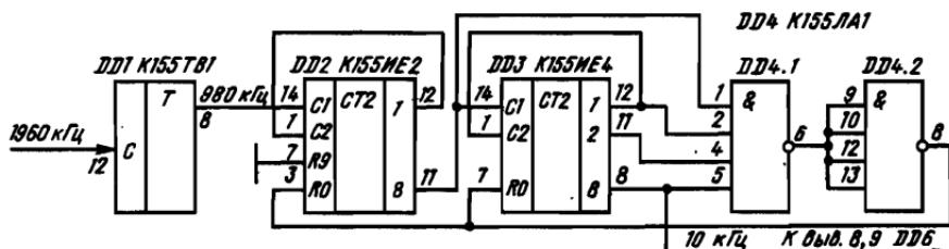
Рис. 61. Схема делителя частоты генератора с кварцевым резонатором на 1,96 МГц
