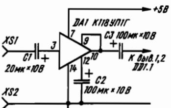
Рис. 26. Усилитель, повышающий чувствительность простейшего частотометра
