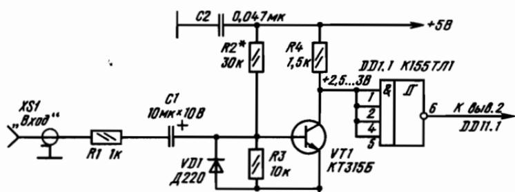
Рис. 57. Формирователь импульсного напряжения на триггере Шмитта микросхемы K155ТЛ1
