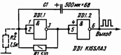
Рис. 12. Вариант мультивибратора на двух элементах 2И-НЕ
