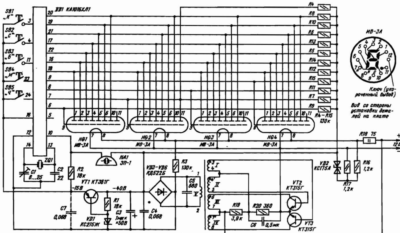
Рис. 63. Принципиальная схема электронных часов
