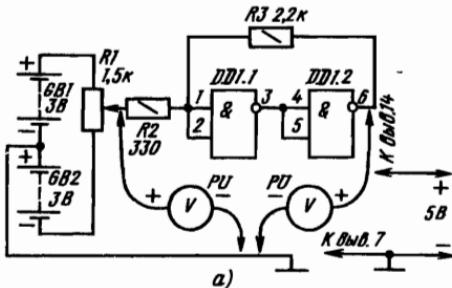
Рис. 23. Опытный триггер Шмитта и графики, иллюстрирующие его работу
