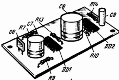
Рис. 21. Плата генераторов испытательных импульсов
