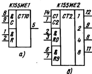
Рис. 41. Условные графические обозначения счетчиков К155ИЕ1 и К155ИЕ2
