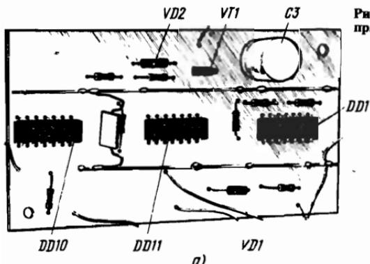
подник), вход С (вывод 3) триггера DD10.1 соедините непосредственно с выходом блока образцовых частот (вывод 5 DD9), что равнозначно установке переключателя SA1 в положение « $\times 1$  Гц», и одновременно с разъемом XS1. Теперь индикатор HG1 будет периодически, примерно через 1,5...2 с (в зависимости от длительности зарядки времязадающего конденсатора C3), высвечивать цифру 1 (1 Гц).
