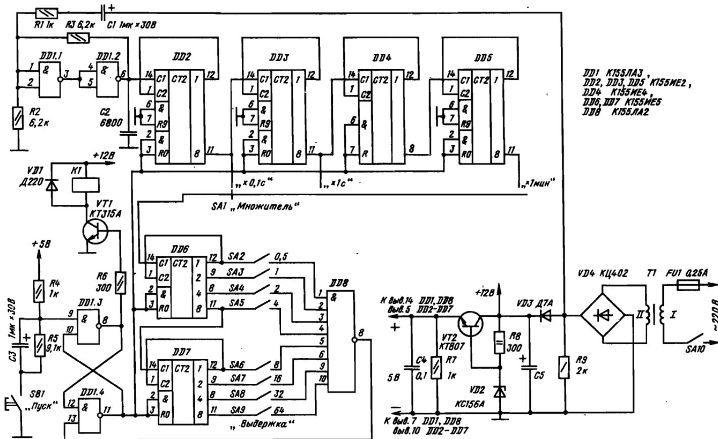
Рис. 44. Принципиальная схема реле выдержки времени
