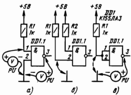
Рис. 8. Опыт с логическим элементом 2И-НЕ
