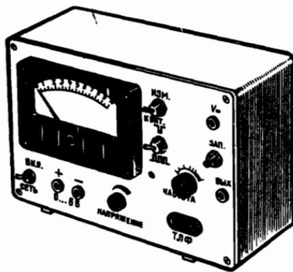
Рис. 22. Внешний вид блока питания с генератором испытательных импульсов
