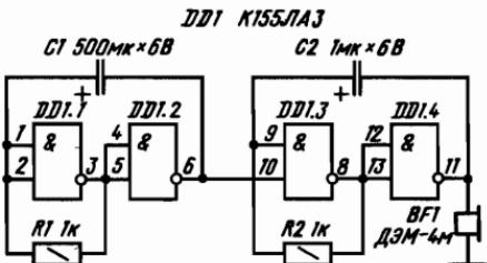
Рис. 14. Схема генератора прерывистого звукового сигнала
