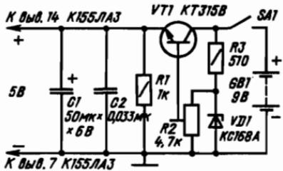
Рис. 6. Простейший блок питания микросхем серии К155
