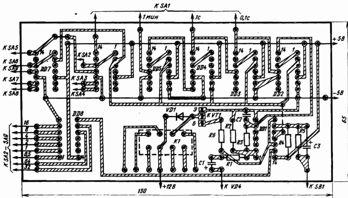
Рис. 45. Монтажная плата реле времени
