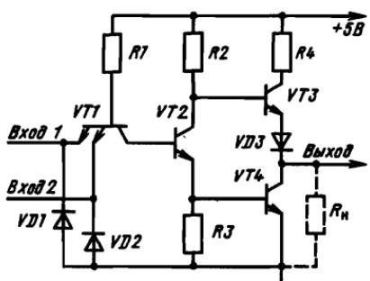
Рис. 9. Схема логического элемента 2И-НЕ микросхемы К155ЛА3
