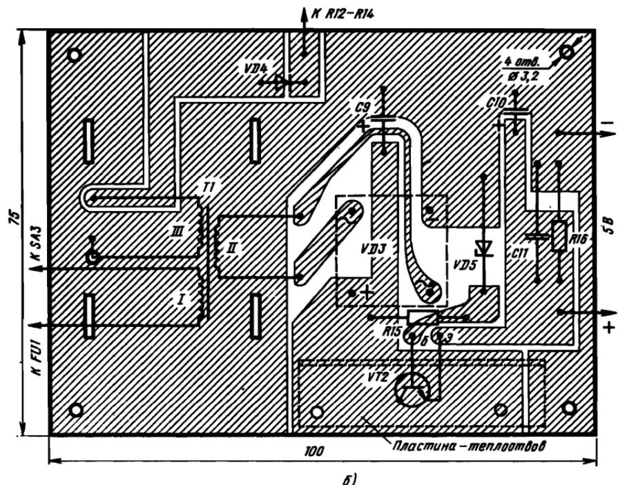
размером  $50 \times 50$  и толщиной 2 мм, выполняющей функцию теплоотвода. Выводы базы и эмиттера транзистора пропущены через отверстия в плате и припаины непосредственно к соответствующим печатным проводникам. Электрический контакт коллектора транзистора с выпрямительным блоком VD3 осуществлен через его теплоотвод, крепежные винты с гайками и фольгу платы.
