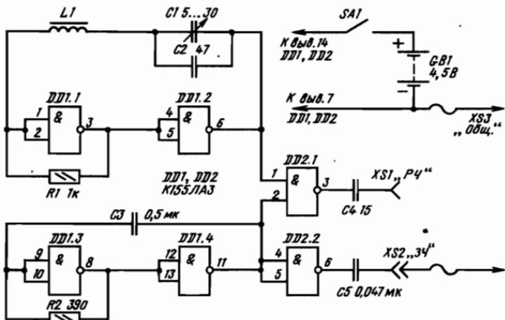
Рис. 17. Генератор ЗЧ-РЧ для проверки трактов радиовещательного приемника
