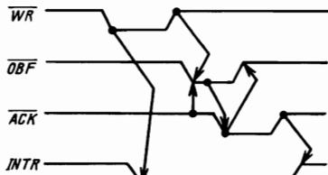
Рис. П.4. Временная диаграмма управляющих сигналов ППА при выводе данных в микроЭВМ в режиме 1
