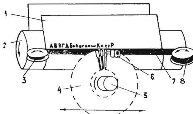
Рис.6. Схема принтера "ромашка": 1 – бумага; 2 – обрезиненный вал; 3,8 – катушка; 4 – сменный диск-шифтоноситель ("ромашка"); 5 – электродвигатель; 6 – электромагнитный молоточек; 7 – красящая лента
