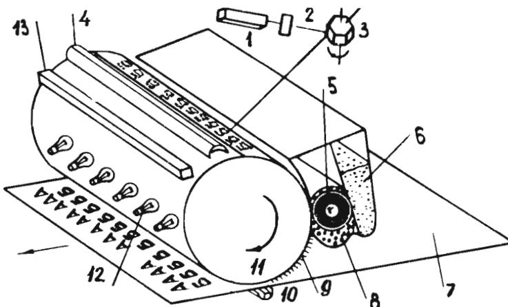
Рис.9. Внутреннее устройство и схема работы лазерного принтера:
