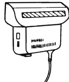
Рис. 23. Ручной сканер
