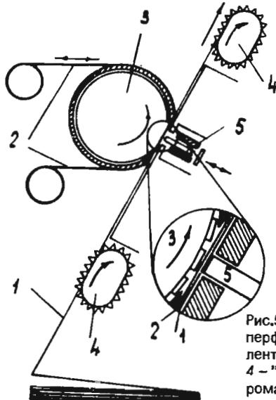
Рис.5. Схема работы АЦПУ: 1 – бумага, перфорированная по краям; 2 – красящая лента; 3 – барабан-шифтоноситель; 4 – "тракторы" подачи бумаги; 5 – электромагнитный молоточек
