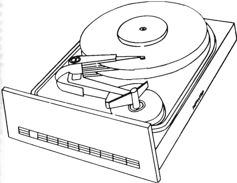
Рис. 18. Образец накопителя на жестком диске ("винчестер")
