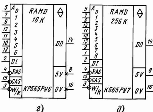
Рис. 2.13. Микросхемы динамических ОЗУ серии K565
