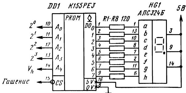
Рис. 4.33. Преобразователь двоичного-десятичного кода в семиэлементный код управления индикатором
