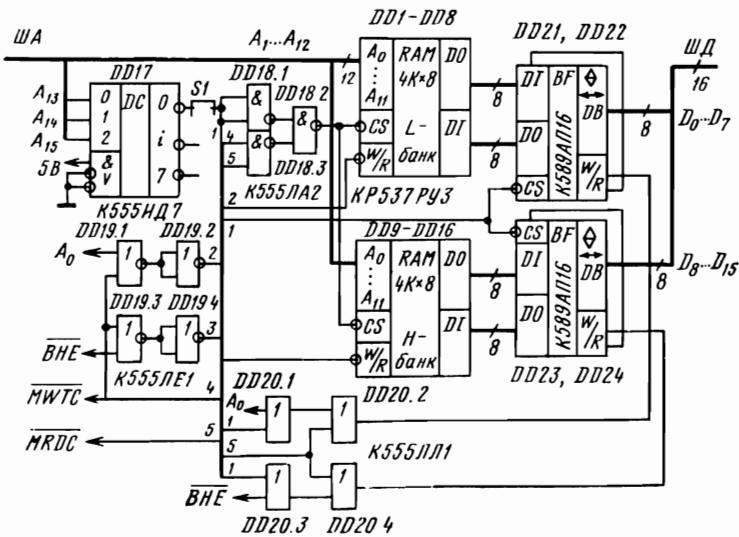
Рис. 4.4. ОЗУ на микросхемах памяти с одноразрядной организацией
