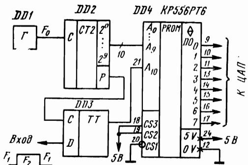
Рис. 4.28. Преобразователь дискретных сигналов в двухтональные
