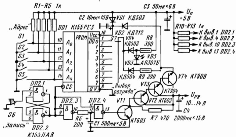
Рис. 3.10. Принципиальная схема программатора микросхем ППЗУ. (вариант 1)
