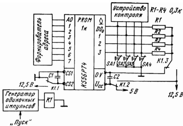
Рис. 3.9. Простейший программатор микросхем ППЗУ
