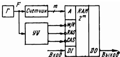
задержки цифровых сигналов микросхемой памяти. Временем задержки можно управлять, изменения емкость накопителя и тактовую частоту.
