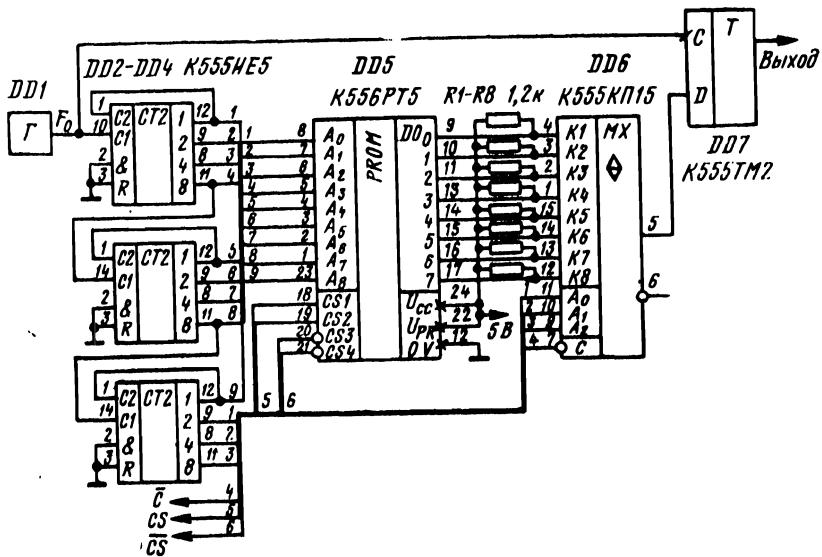
Рис. 4.26. Формирователь сигналов управления с программируемой временной диаграммой
