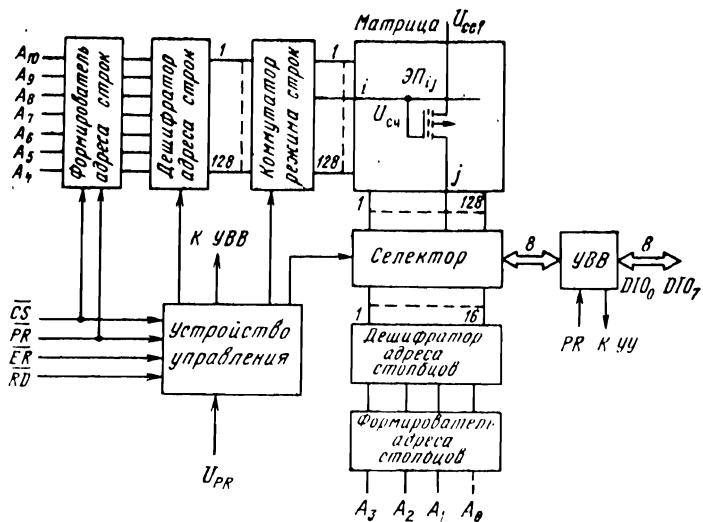
Рис. 1.17. Структура микросхемы ЭСППЗУ
