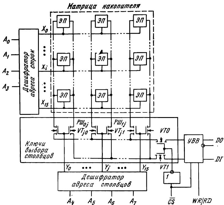
Рис. 1.3. Структура микросхемы ОЗУ с одноразрядной организацией
