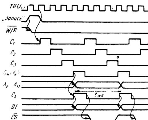
Рис. 4.18. Временные диаграммы сигналов буферного ОЗУ
