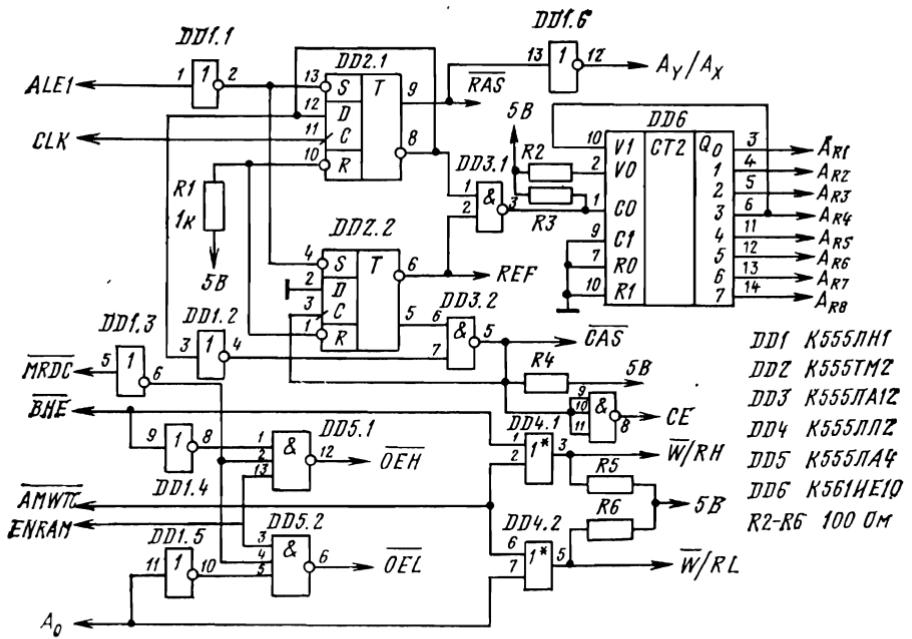
Рис. 4.14. Схема контроллера для блока ОЗУ на рис. 4.13
