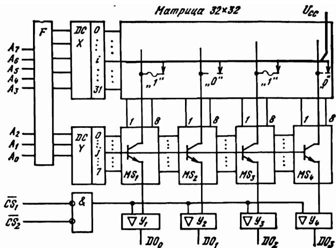
Рис. 1.11. Структура биполярной микросхемы МПЗУ
