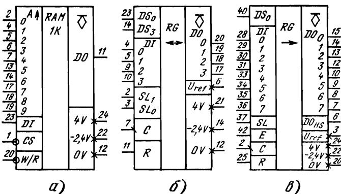
Рис. 2.12. Арсенид-галлиевые микросхемы серии К6500:
