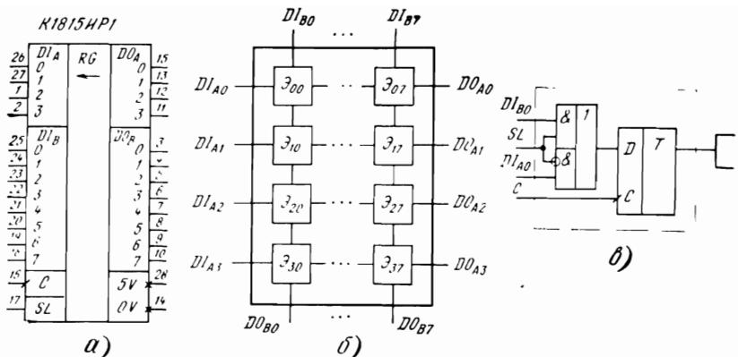
Рис. 2.10. Многорегистровая микросхема К1815ИР1 с матричной структурой:
