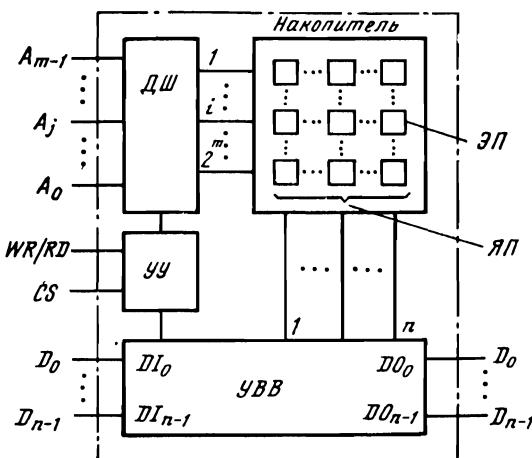
Рис. 1.2. Обобщенная структурная схема ЗУ
