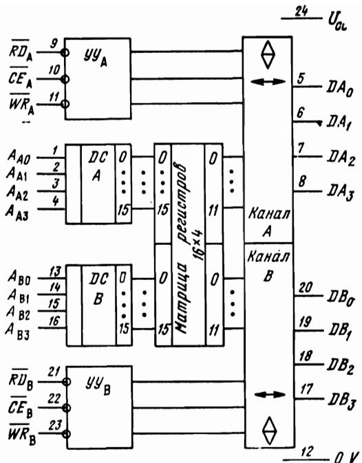
Рис. 2.7. Структура микросхемы регистрового ЗУ KP1802IP1
