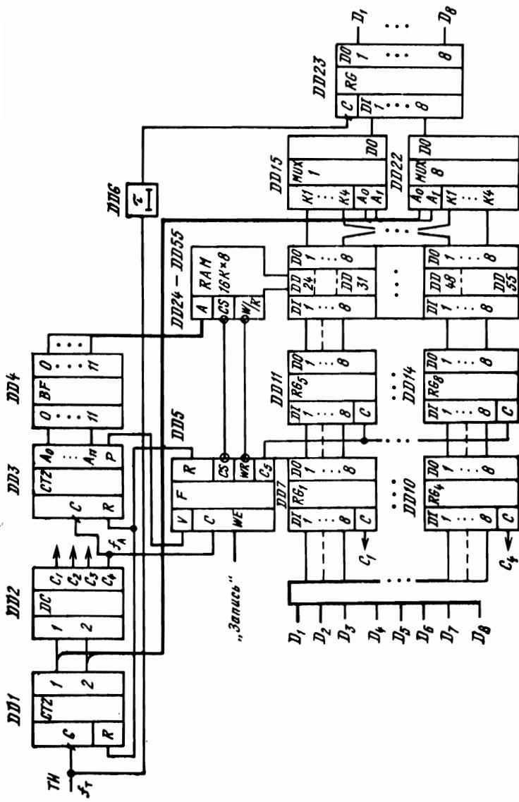
Рис. 4.17. Быстро действующее буферное ОЗУ с многоканальным трактом записи
