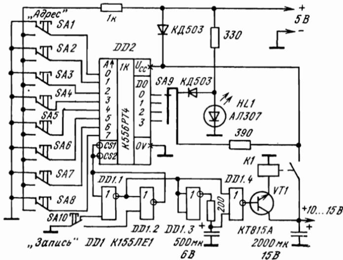
Рис. 3.11. Принципиальная схема программатора микросхем ППЗУ (вариант 2)
