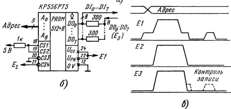
Рис. 3.12. Устройство автоматического программирования микросхем ПЗУ:
