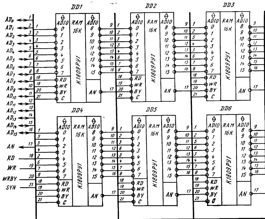
Рис. 4.7. ОЗУ на микросхемах памяти с встроенным интерфейсом
