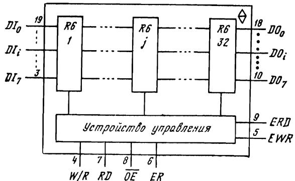
(FIFO) емкостью  $32 \times 8$  бит. Она содержит 32 восьмиразрядных регистра, соединенных так, что параллельные выходы предыдущего соединены с соответствующими входами последующего. Входы первого регистра являются и входами микросхемы DI<sub>0</sub>... DI<sub>7</sub>, а выходы последнего — выходами микросхемы DO<sub>0</sub>... DO<sub>7</sub>. Выходы могут принимать три состояния.
