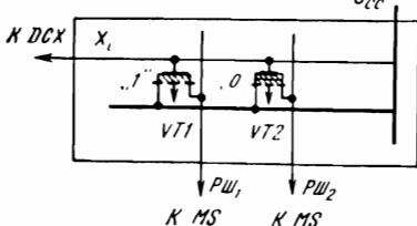
своей группы и коммутируют ее на выход. На выходе каждого селектора включен усилитель считывания, управляемый сигналами  $\overline{CS}_1$  и  $\overline{CS}_2$ . При состоянии этих сигналов лог. 0 усилители открыты для считывания информации, при любых других состояниях указанных сигналов усилители будут закрыты и иметь на своих выходах уровни лог. 1.
