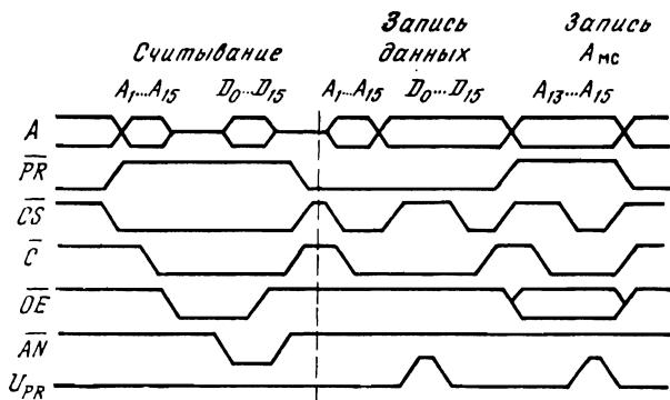
Рис. 3.8. Временные диаграммы сигналов микросхемы СППЗУ К573РФ3
