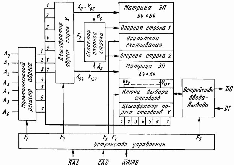
Рис. 1.8. Структура микросхемы динамического ОЗУ
