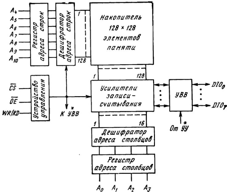
Рис. 1.5. Структура микросхемы ОЗУ со словарной организацией
