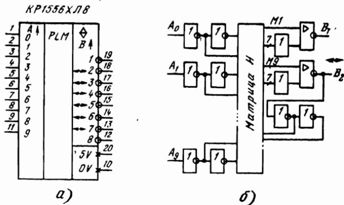
Рис. 3.4. Микросхема ПЛМ KP1556ХЛ8:
