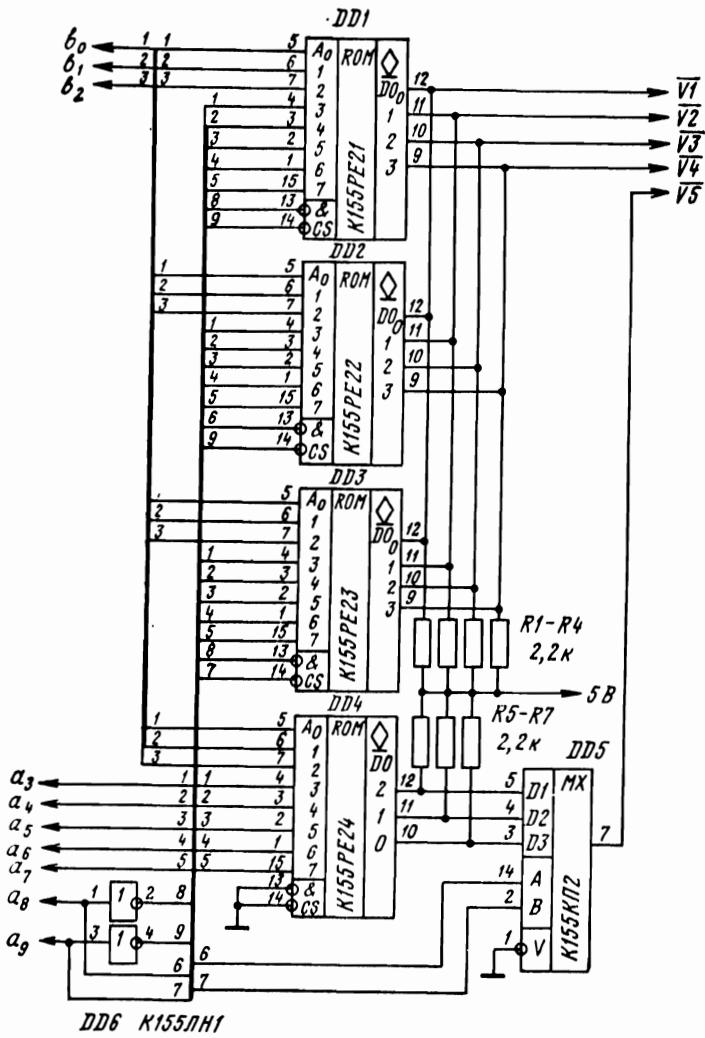
Рис. 4.29. Знакогенератор на микросхемах МПЗУ серии К155
