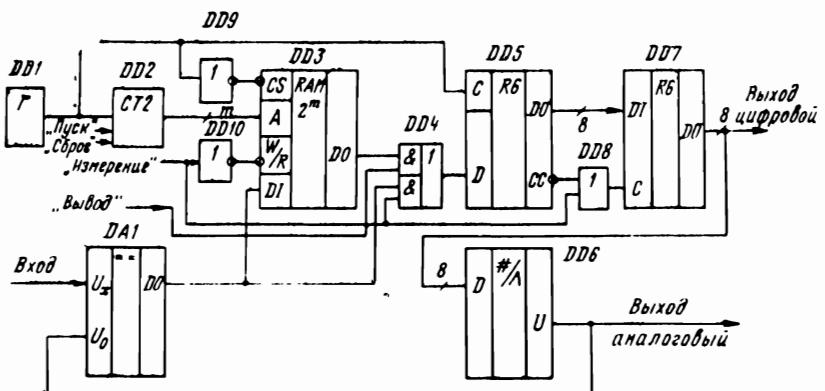
Рис. 4.23. Устройство аналого-цифрового преобразования сигналов с буферной памятью
