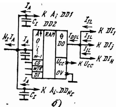
Рис. 1.19. К определению статических параметров микросхем памяти
