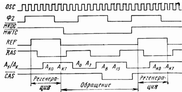
Рис. 4.12. Временные диаграммы сигналов управления динамического ОЗУ
