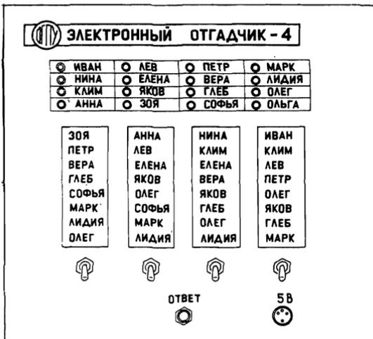
Рис. 15. Передняя панель отгадчика имен
