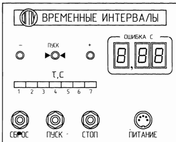
Рис 113 Передняя панель тестера «Временные интервалы»
