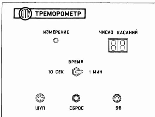
Рис. 117. Передняя панель треморометра
