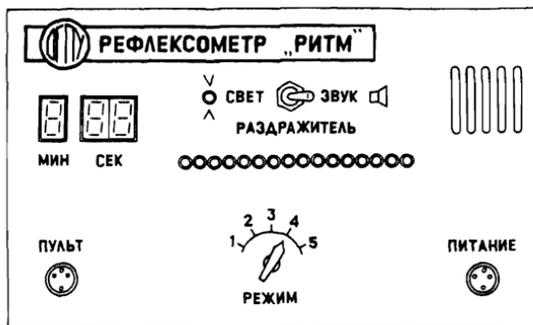
Рис. 101. Передняя панель рефлексометра «Ритм»
