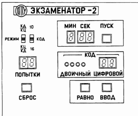
Рис. 74. Передняя панель автомата «Экзаменатор-2»
