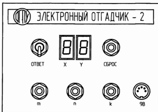
Рис. 10. Передняя панель отгадчика двузначных чисел
