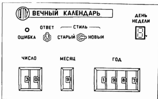
Рис 65 Передняя панель устройства «Вечный календарь»
