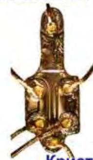
ИС P12-2 Германиевая пластина. Сентябрь 1962 г.
