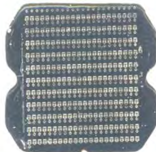
ИС P12-2 Германиевая пластина. Сентябрь 1962 г.
