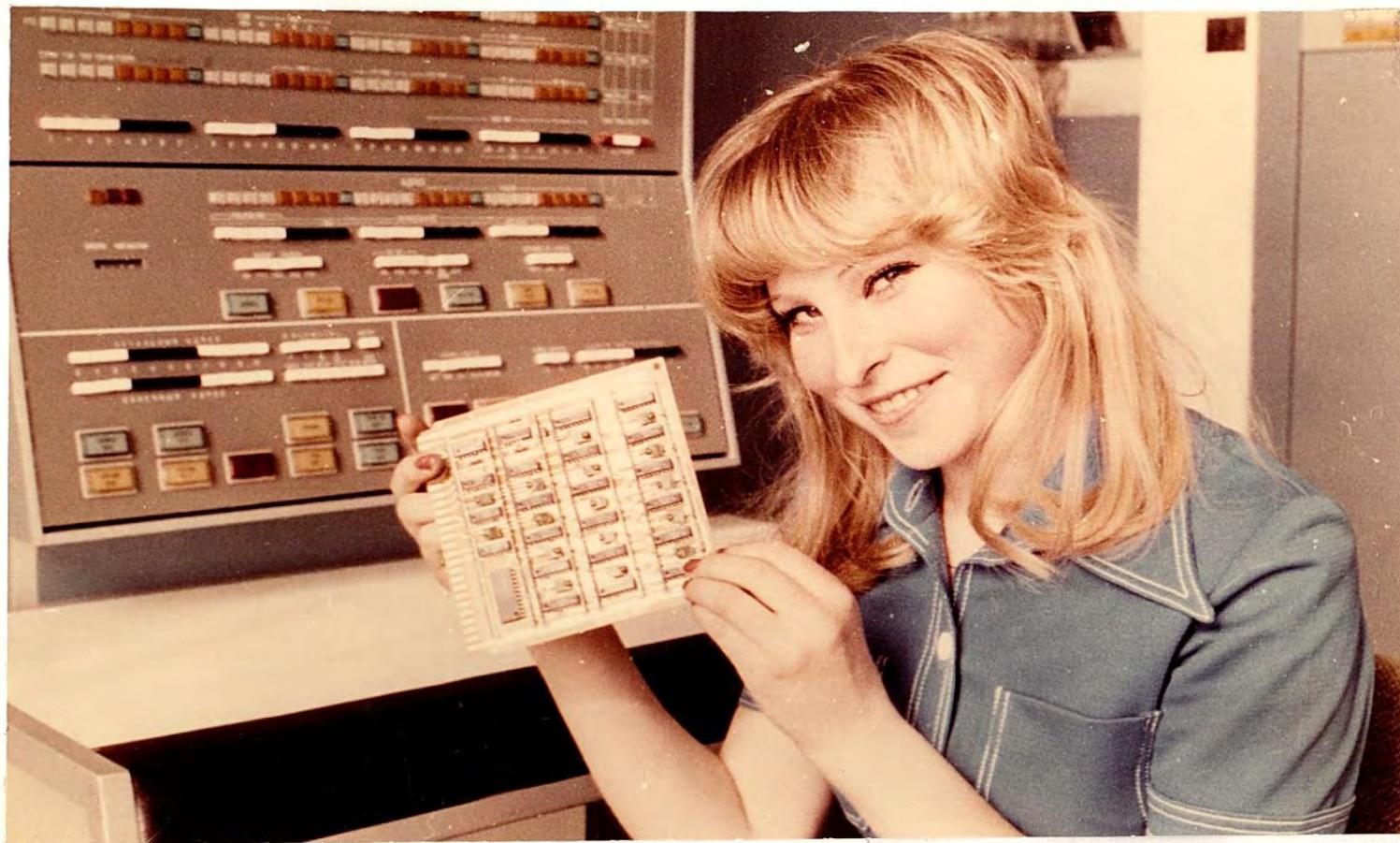
Типовой элемент замены — стандартный блок ЕС-1033
