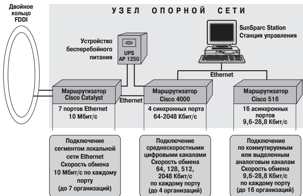
Рис. 18. Состав аппаратного комплекса базового узла. Типы подключения организаций к узлу опорной сети
