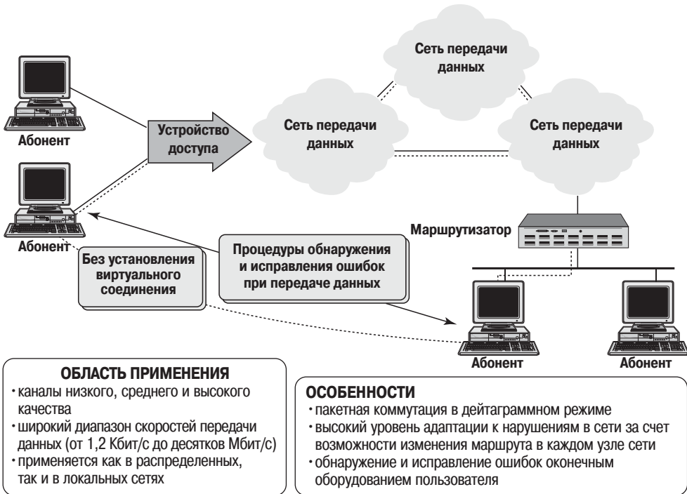
Рис. 3. Фрагмент взаимосвязи сетей с использованием протокола TCP/IP
