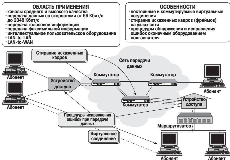
Рис. 6. Фрагмент сети с использованием процедуры Frame Relay
