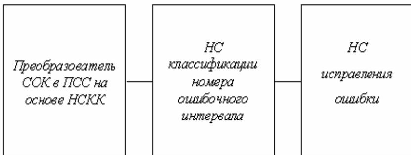
Рис.4. Структура нейронной сети для определения и исправления ошибок в модулярных нейрокомпьютерах
