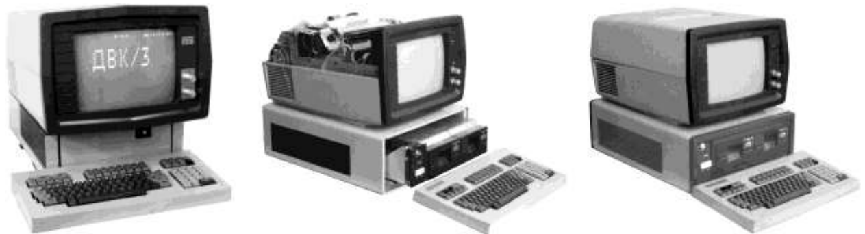
Рис. 74. Варианты унифицированного моноблока ДВК-3 и ДВК-4 (в центре – с встроенным сверху принтером)
