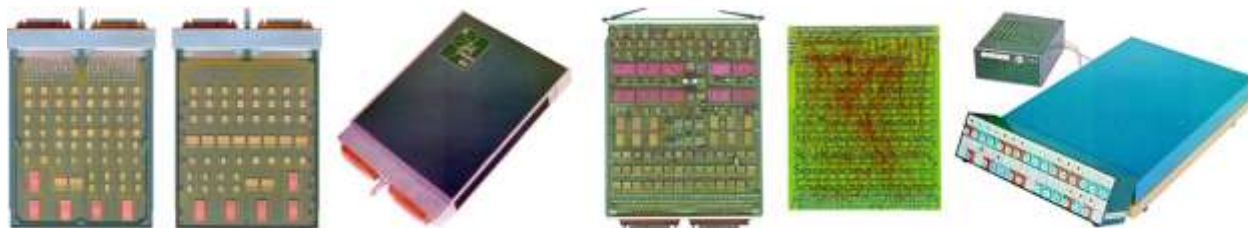
Рис. 43. Микро-ЭВМ Электроника НЦ-01(слева) и НЦ-02 (справа), платы и в сборе
