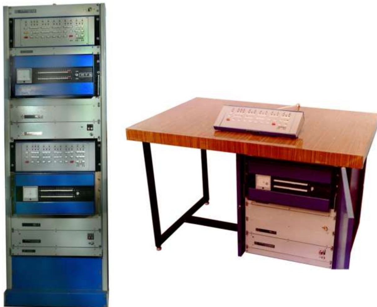
Рис. 52. Стойка МКТК «Электроника НЦ-32» и его абонентский пункт
