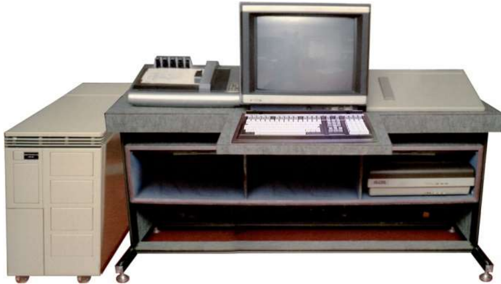
Рис. 94. «Электроника НЦ-ИРС-32» с графопостроителем (слева), дигитайзером (справа) и принтером (в столе)
