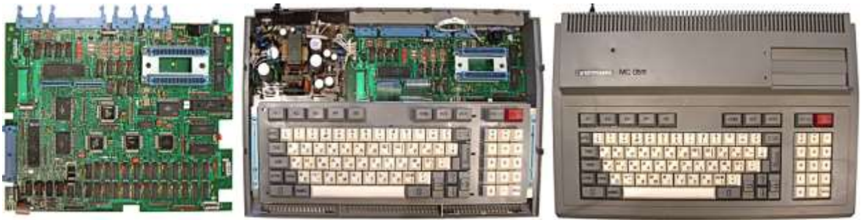
Рис. 85. Школьная ЭВМ «Электроника УК-НЦ» (МС 0511): плата, внутреннее устройство, внешний вид
