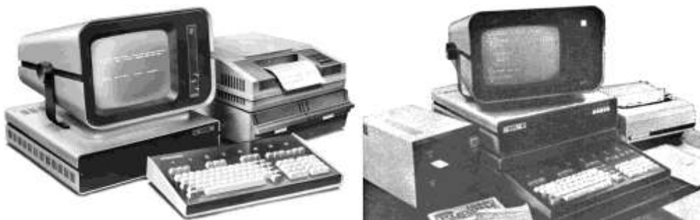
Рис. 73. ДВК-2 с 8-дюймовым НГМД и термопринтером и ДВК-2М с 5-дюймовым НГМД и матричным принтером, всё производства МЭП
