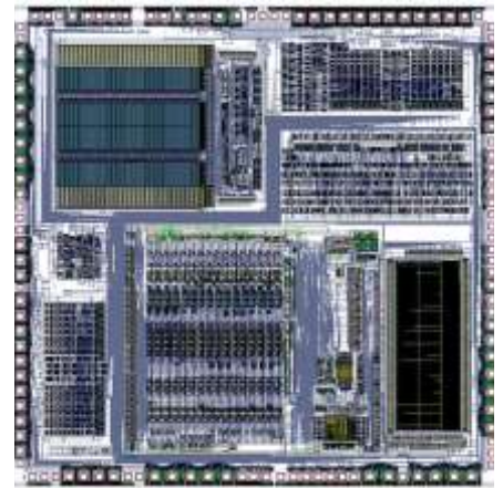
Рис. 102. Л1875ВЕ1 – 2-й вариант фрагментно-модульного микроконтроллера ЛКТБ "Светлана", 1987 г.
