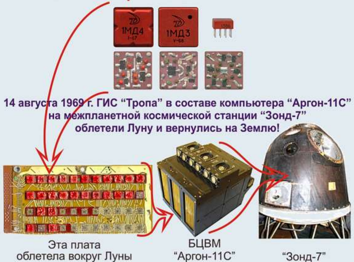
Рис. 24. ГИС серии Тропа – первые микросхемы в мире, облетевшая Луну и вернувшаяся на Землю (юбилейный планшет)
