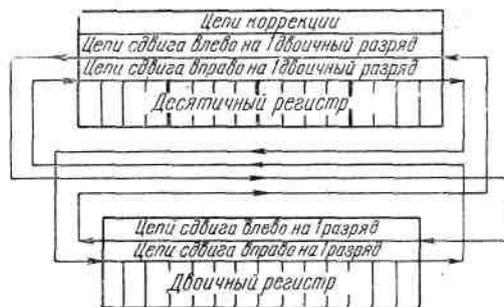
Рис. 5-7. Построение устройства для преобразования чисел из десятичной системы в двоичную и из двоичной в десятичную.
