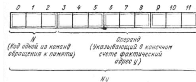
Рис. 3.1. Условное отображение и список команд обращения к памяти: 0у — логическое умножение содержимого НР (СМ) на содержимое ячейки по адресу у; 1у — (сложение) прибавление к содержимому НР (СМ) содержимого ячейки по адресу у (если возникает «1» переполнения, она прибавляется к содержимому ДР (ДРС)); 2у — увеличение содержимого ячейки по адресу у на 1 и пропуск очередной команды, если новое содержимое оказывается равным нулю; 3у — посылка содержимого НР (СМ) в ячейку по адресу у с (последующим) обнулением НР (СМ); 4у — обращение к подпрограмме с начальным адресом у; 5у — безусловная передача управления по адресу у.
