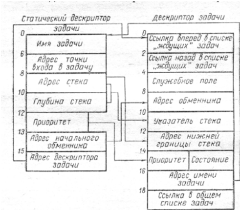
Рис. 4.9. Упрощенная структура статического дескриптора задачи и дескриптора задачи
