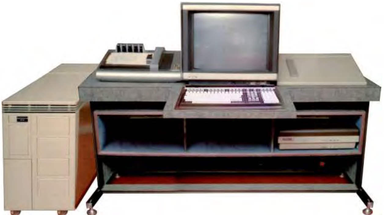
Рис. 26. ИРС-32 – последняя отечественная (МЭП) разработка аппаратно-программного комплекса САПР ИЭТ (на основе двух 32-разрядных одноплатных микро-ЭВМ «Электроника-32»).
